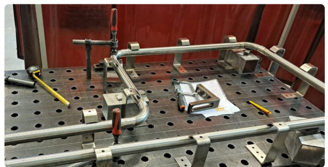
SCHWEISSTISCH Rohr und Deckenabhängerg nach Zeichnung ausgerichtet und WIG-verschweißt
