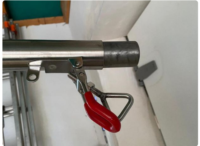
KUPPLUNG Spannverschluss am Rohrende, die Verlängerung wird angesetzt und verriegelt
