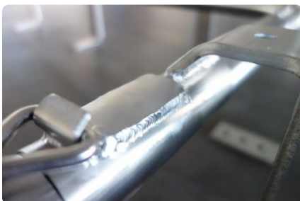
WIG-NAHT Halter am Rohr verschweißt und gebeizt
